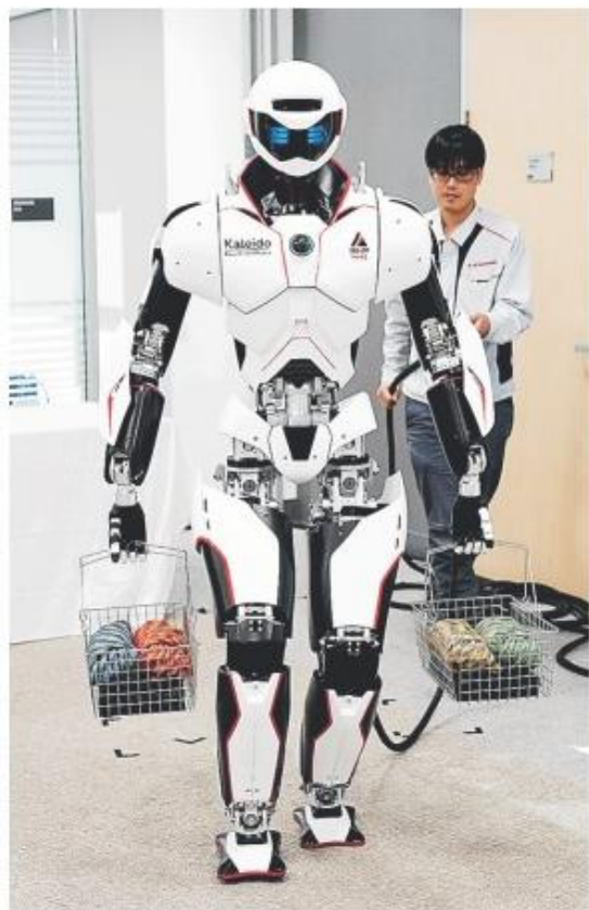
フィジカルAI化に向けて川崎重工が開発している一足歩行ロボット。製造業での活躍を目指す(同社提供)
