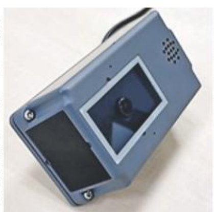
スピーカーとマイクを内蔵した電車内用のAIカメラ(アイテック阪急阪神提供)
