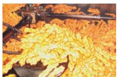
姫路市船津町の工場で作られる播州駄菓子。油温を変えた4つの釜に数分ずつ移し替えて揚げるなど、手作業の良さを残すオリジナル機械もおいしさの秘訣。要所に人の手が。
