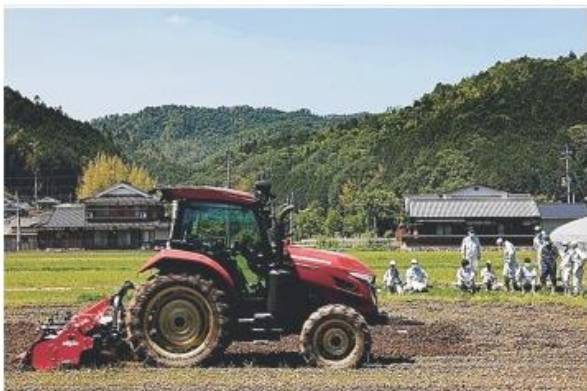
運転席に人が乗らずに、自動で農地を耕すトラクター＝2021年6月、丹波篠山市福住
