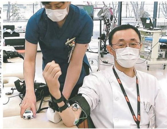
「HAL」単関節タイプは、動かしたいと思うだけで、微弱な電気信号を読み取り動きをサポートする。いずれも尼崎市東灘区町の兵庫県立尼崎総合医療センター
