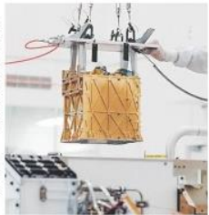
火星の探査車パーシビアランスに搭載された酸素をつくり出す実験装置(NASA提供)
