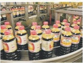
④ 全長1800センチ、幅3センチの布からしょうゆを搾り出す。⑤ ヘルトコンベヤーで箱詰め作業工程に向かうしょうゆのボトル
